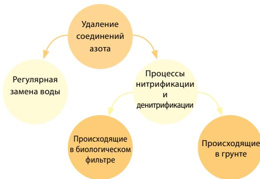
жизни кислород они вынуждены получать из химических соединений, в том числе из нитрат-ионов. Ионы, отдав кислород бактериям, превращаются в молекулярный азот, который затем испаряется из аквариума. Таким образом, соединения азота полностью удаляются из воды. Этот процесс называется денитрификацией.
