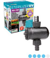
Основным его элементом является камера, содержащая 3-ватную лампу, излучающую губительный для нежелательных водорослей, простейших и бактерий ультрафиолетовый свет UV-C (254 нм). Скорость прохождения воды через этот стерилизатор не должна превышать 650 л/ч (поэтому для 3Вт нельзя использовать более мощные фильтры – это будет не эффективно). Устройство не требует дополнительного обслуживания, а срок службы ультрафиолетовой лампы составляет 5000 часов (после этого ее необходимо заменить);
